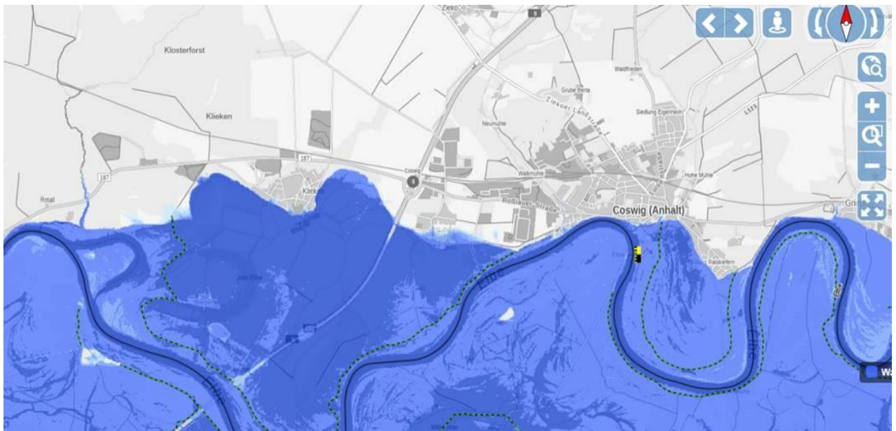
Abbildung 2: Hochwasserrisiko (ohne Beachtung der Deiche und Hochwasserschutzmaßnahmen bzw. beim Versagen dieser Maßnahmen) für ein Hochwasser mit niedriger Wahrscheinlichkeit, HQ 200
