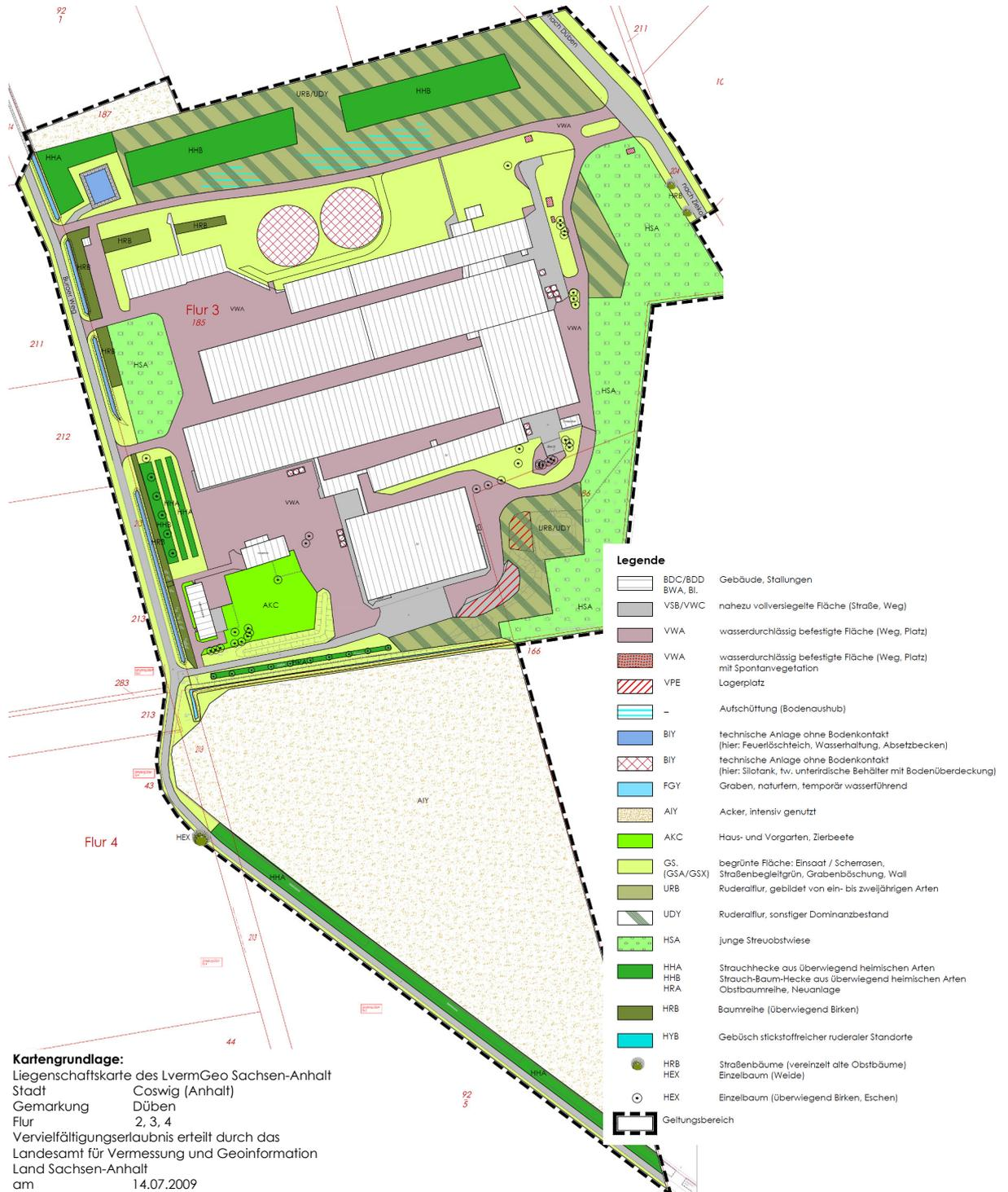
**Abbildung 1:** Ausschnitt aus dem aktuellen Vorhaben- und Erschließungsplan mit Biotop- und Nutzungstypen mit umrissenen Geltungsbereich (Büro Schwerdt, Dessau - Roßlau 2015<sup>7</sup>)
